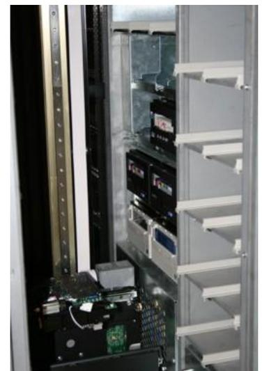
*Innenansicht eines Bandwechselroboters*
