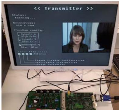
Versuchsaufbau Videoübertragung über FlexRay
