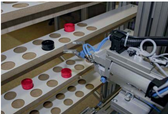
Bewegungssteuerung im Hochregal (Motion-Control-Demonstrationsanlage)
