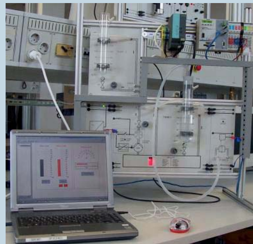
Digitale Füllstandsregelung mittels Speicherprogrammierbarer Steuerung, Visualisierung und Bedienung mittels PC (Demonstrationsanlage im Labor für Simulation, Steuerung und Regelung)
