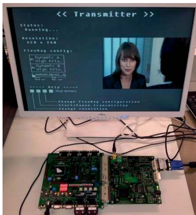
Versuchsaufbau Videoübertragung über FlexRay
